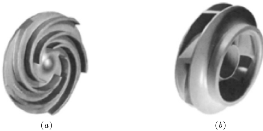
FIGURA 3 – (a) Rotor do tipo aberto, (b) Rotor do tipo fechado. Extraído de Munson et al. (2004).
