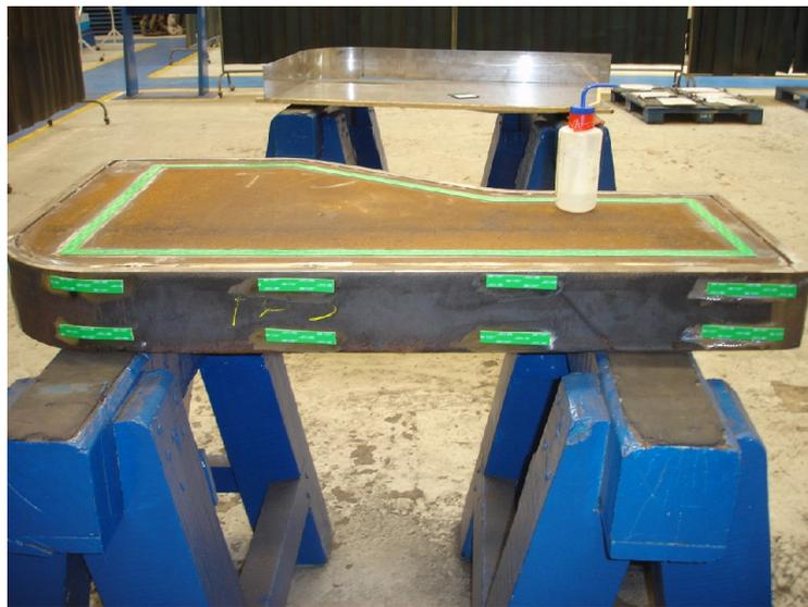
**Figura 9: Fitas aplicadas antes da aplicação do revestimento**
