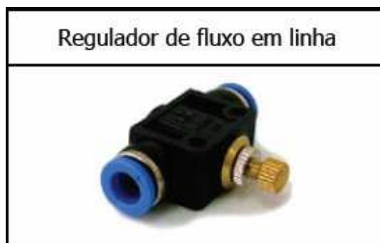
Existem basicamente dois tipos válvulas reguladoras de fluxo, as compensadas e as não compensadas. As válvulas de fluxo compensadas, por meio de uma mola interna, podem aumentar com o aumento da queda de pressão na válvula e assim, aplicar um fluxo constante mesmo em linhas com pressão variável. Por esse motivo, esta válvula seria a mais indicada para esta aplicação, uma vez que a força (e, portanto a pressão) de infusão varia ao longo do tempo e busca-se um fluxo de infusão constante.
