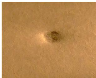
Figura 19 – Impressão Braille com placa de impressão em alto relevo redondo e espuma acima do papel
