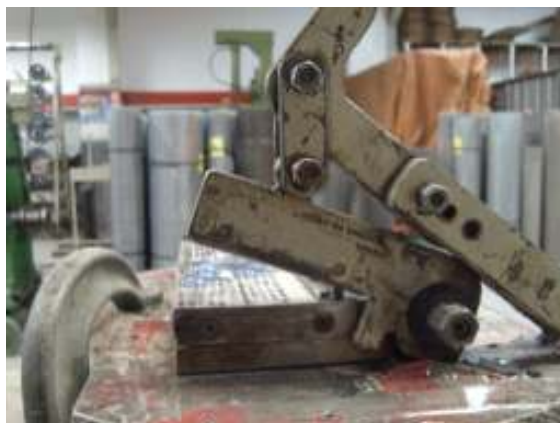
Figura 7. Mecanismo alternativo guilhotina.
