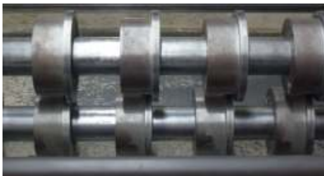
Figura 8. Mecanismo de lâminas giratórias
