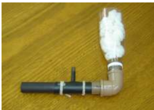
Figura 1. Dispositivo de teste para ar comprimido.
