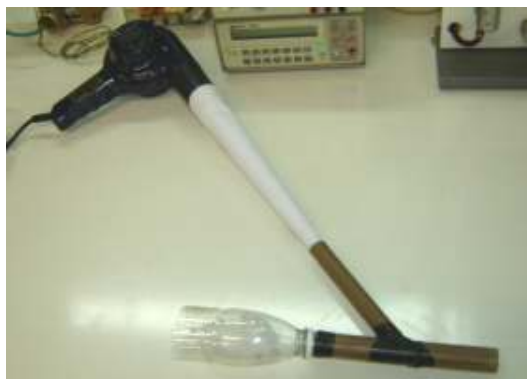
Figura 2. Dispositivo de teste para ventilador.
