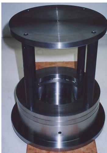
Figura 11. Dispositivo para ensaio de conformação hidrostática fabricado nos laboratórios da EPUSP.
