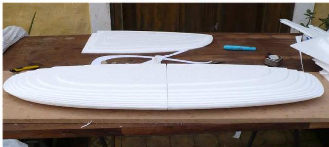
Figura 9. Seções do casco de 5mm de espessura em EPS
