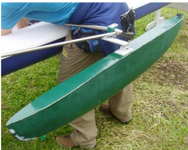
Figura 10. Protótipo do Flutuador
