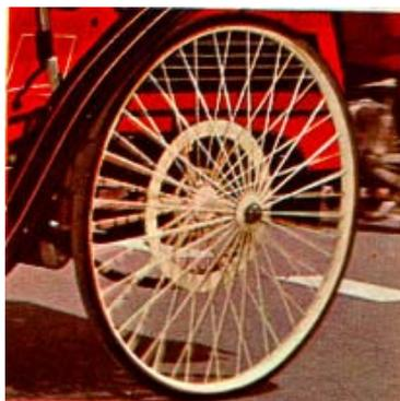
Figura 1. Roda com aros de metal coberta de borracha.
