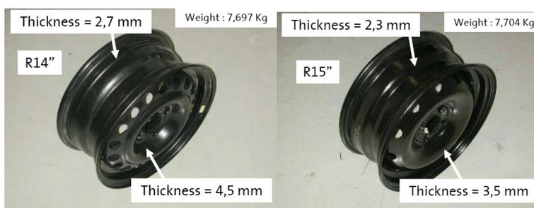
Figura 8. Roda do veículo Chevrolet Corsa (esq.) e Dacia Logan (dir.) e suas espessuras de chapa
