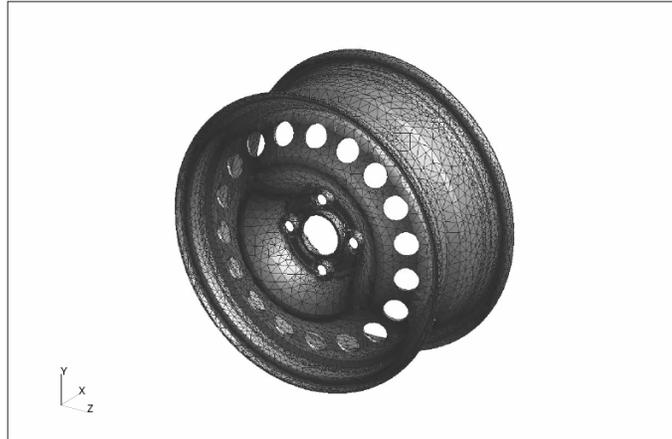
Figura 8: Modelo discretizado da roda, utilizando elementos sólidos tetraédricos de 10 nós.
