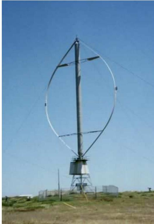
Figura 4.3 – Turbina eólica de eixo vertical
