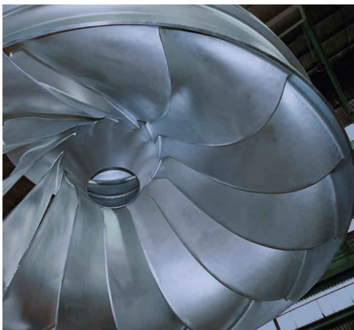
Figura 1 – Vista Inferior da turbina Francis da Usina de Capivara
