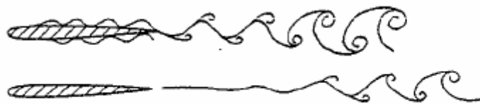
Figura 24 - Formação da esteira em fólhos para o caso de alto e baixo número de Reynolds (extraída e adaptada de [7])
