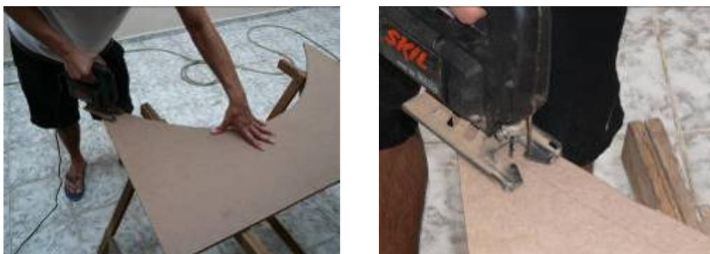
**Fig.14. 6** – Detalhe de corte do MDF em formato parabólico.
