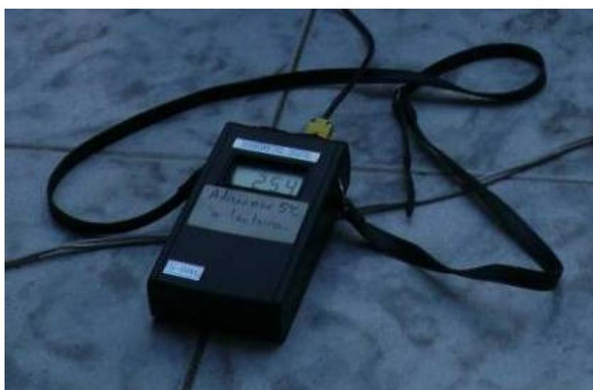
**Fig.14. 23** – Termopar para medição da temperatura do reservatório.
