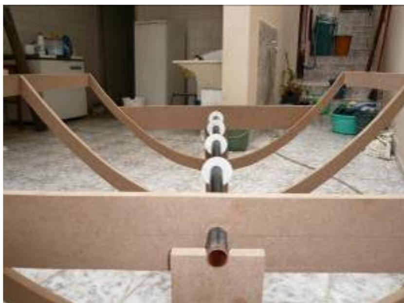
**Fig.14. 14** – Anéis plásticos para apoio das transparências.
