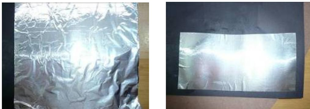
**Fig.14. 9** – Testes de colagem da superfície refletora.
