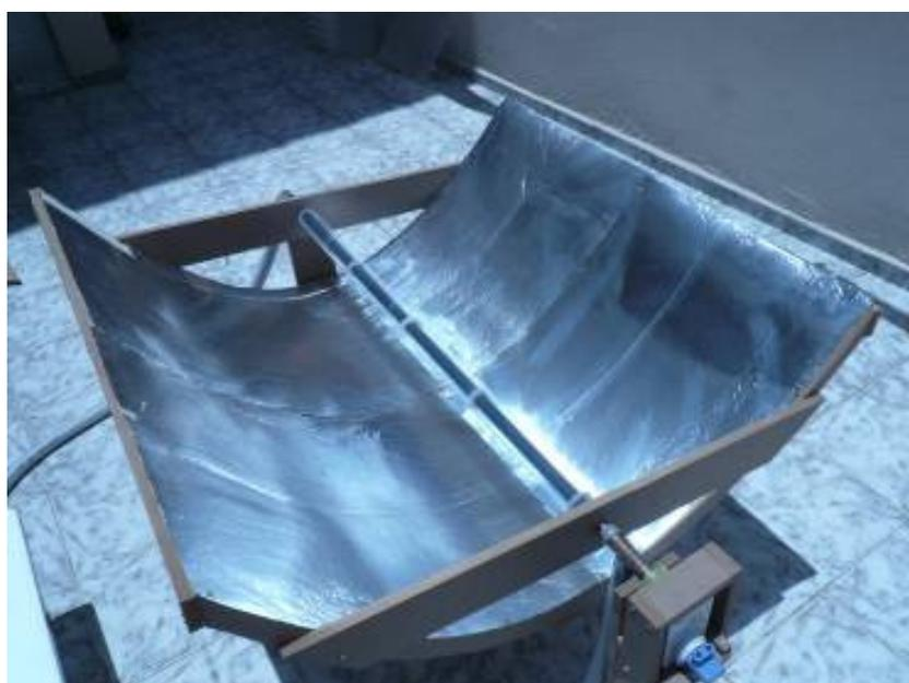
**Fig.14. 11** – Superfícies refletoras sobre a estrutura.
