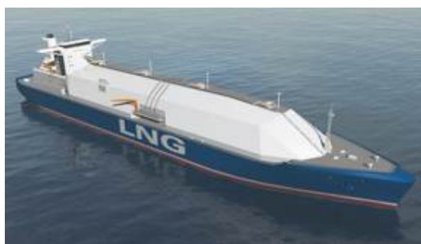
Figura 9- Transportadora tipo membrana (Technigaz) [6]
