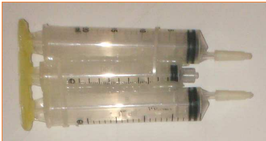
Fig. 40: Configuração que utiliza duas seringas de 20 ml como propulsora e uma seringa de 10 ml como reservatório.
