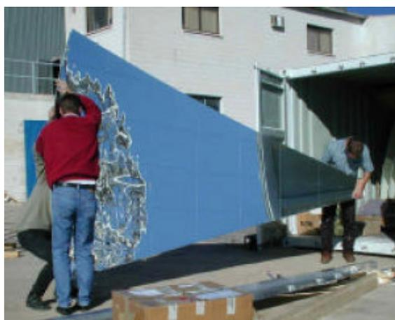
Fig. 3.5 – Segmento do coletor parabólico (EuroDish, 2002)
