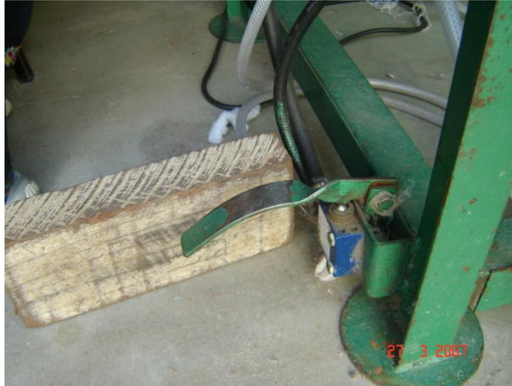
Fig. 3.5 - Pedal de controle da vazão
