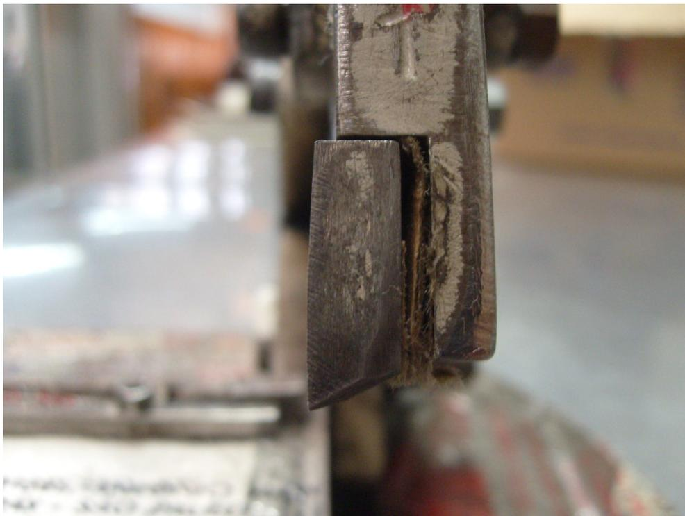
Fig. 7.4 - Detalhe da lâmina da guilhotina
