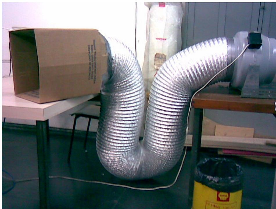
Fig. 6.14 - Vista geral do captor, duto e ventilador
