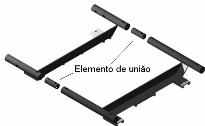
Figura 13: Detalhe da estrutura da base.
