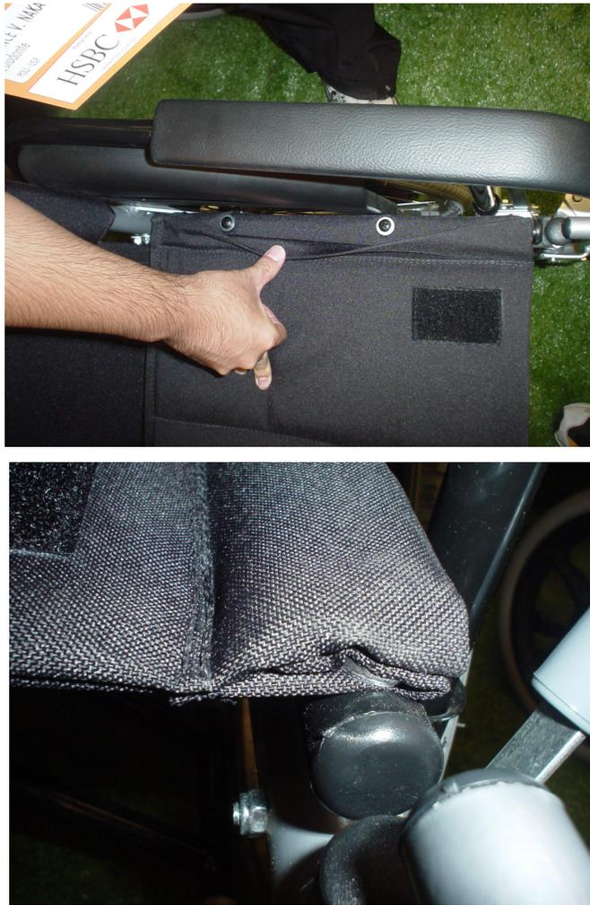
Figura 19: Deformação do tecido com o tempo (Fonte: Reatech).
