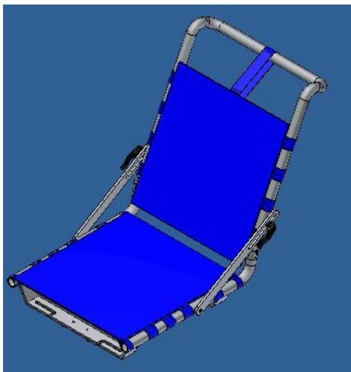
Figura 5.8: Estrutura da cadeira com assento e encosto
