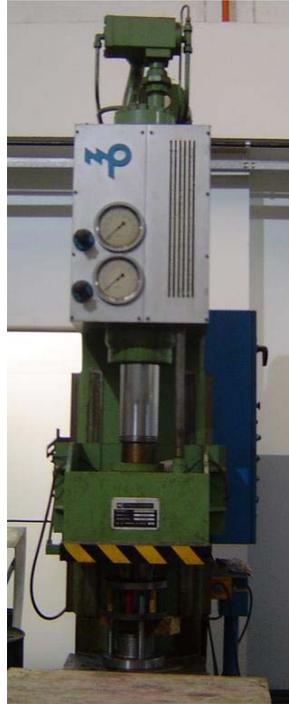
*Figura 33 – Prensa Hidráulica: Capacidade 300KN (laboratório EPUSP)*
