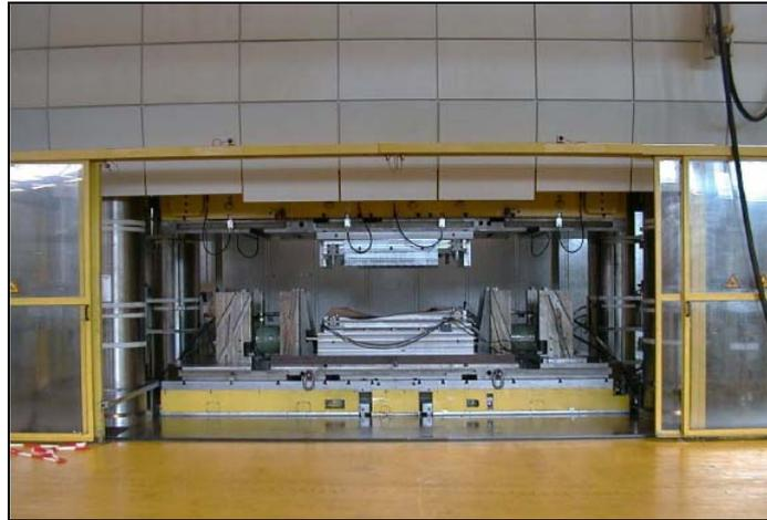
*Figura 5 – Exemplo de prensa utilizada para hidroconformação (Schuler)*
