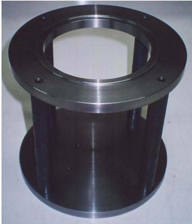
*Figura 44 – Prensa-chapas, colunas e suporte (parte superior do dispositivo)*
