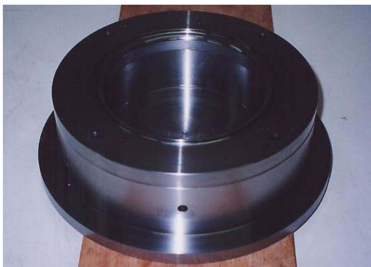
*Figura 43 – Base e matriz cilíndrica*
