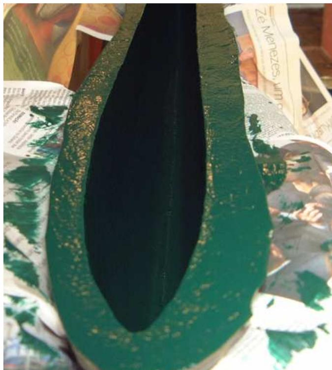
**Figura 5.13: Molde com aplicação de gel coat**
