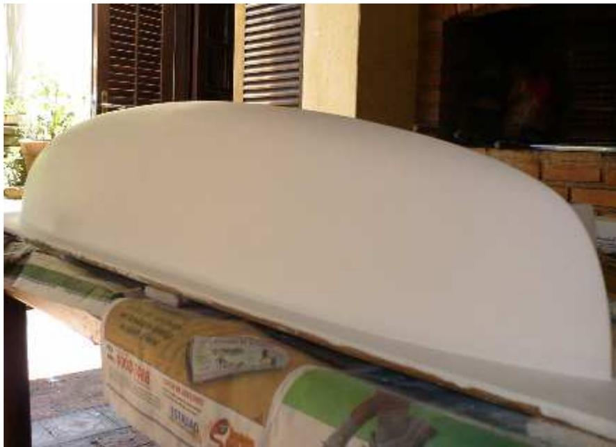
**Figura 5.10: Modelo revestido com PVA, vista lateral**
