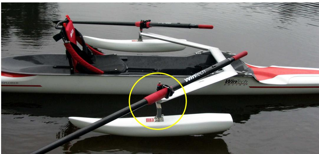
**Figura 1.2: Detalhe do dispositivo de fixação no braço da forqueta\* (Wintech Racing, 2007).**
