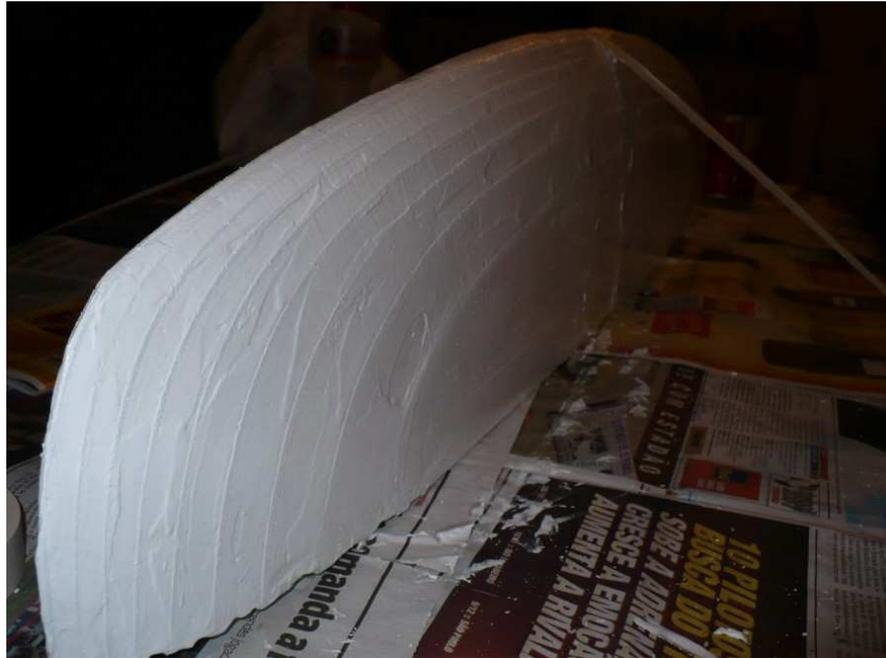
**Figura 5.9: Modelo revestido com PVA, vista inclinada**
