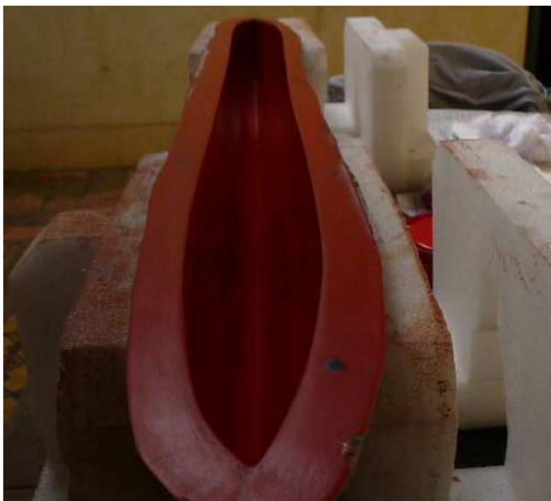
**Figura 5.12: Molde já preparado para laminação**
