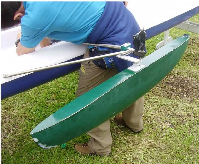
**Figura 6.32: Protótipo Montado no Barco (lado esquerdo).**
