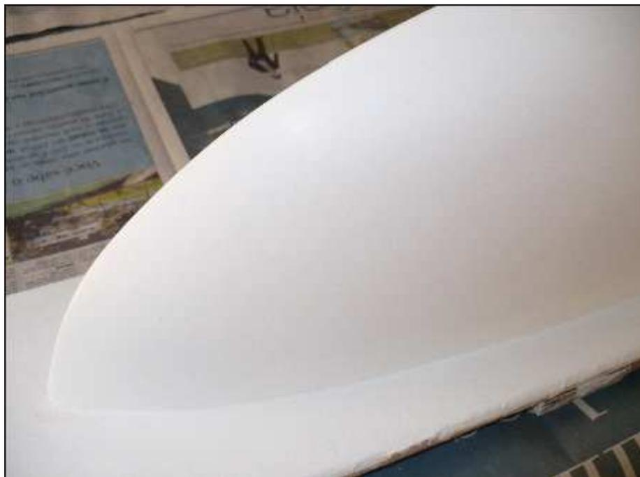
**Figura 5.11: Modelo revestido com PVA**
