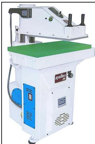
Figura 6 – Balancim hidráulico
