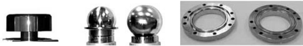
Fig. 4.7 – Formatos de punções (esq.) e anéis de fixação (dir.).
