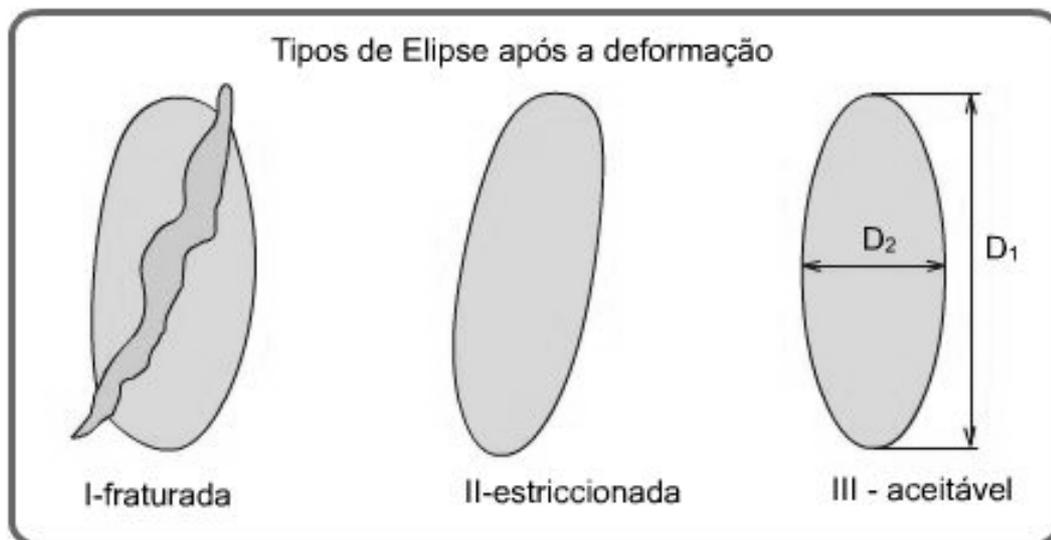
Fig. 4.11 – Elipses possíveis após a deformação: tipo I (fraturada, ou seja, a fratura passa pela elipse), tipo II (afetada pela fratura ou estriçada) ou tipo III (aceitável, a elipse encontra-se fora da área estriçada ou fraturada).
