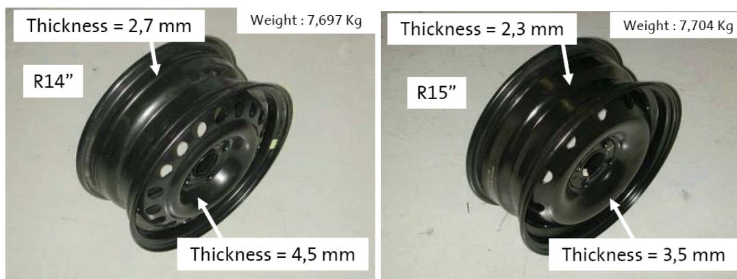
Fig. 9.3 – Roda do veículo Chevrolet Corsa (esq.) e Dacia Logan (dir.) e suas espessuras de chapa
