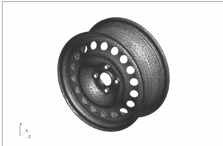
Figura 42: Modelo em elementos finitos da roda em estudo
