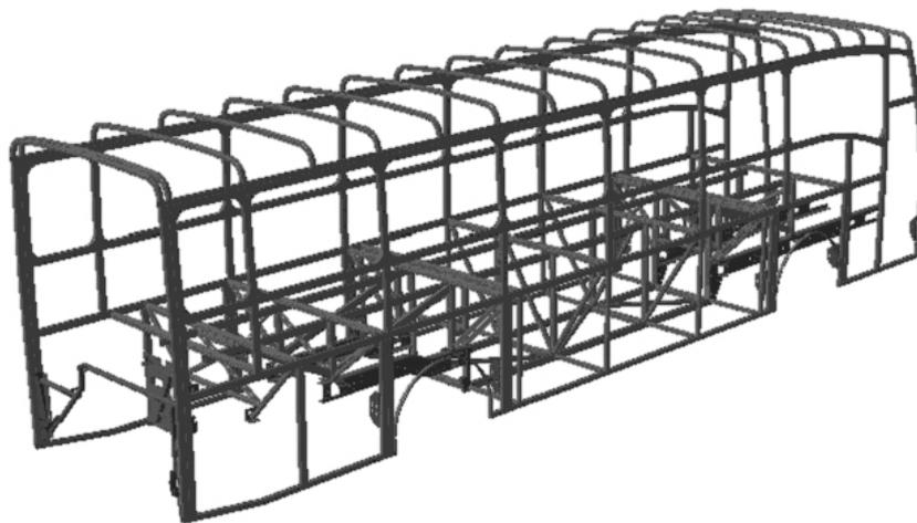
Figura 10: Representação de ônibus rodoviário em software CAD.
