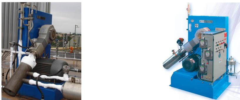
Figura 5. Bomba criogênica modelo PD3000 – fabricante Cryostar
