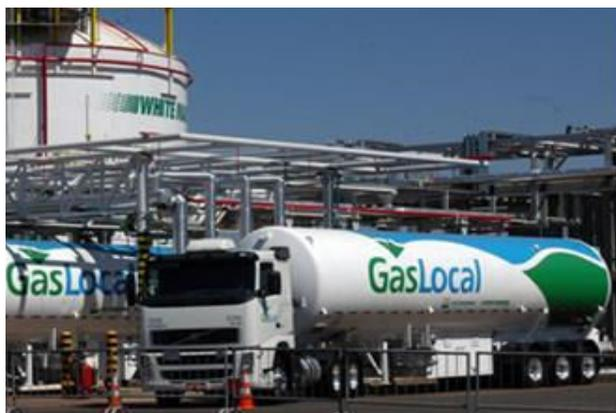
Figura 1. Caminhão Equipado com Carreta para Transporte de GNL
