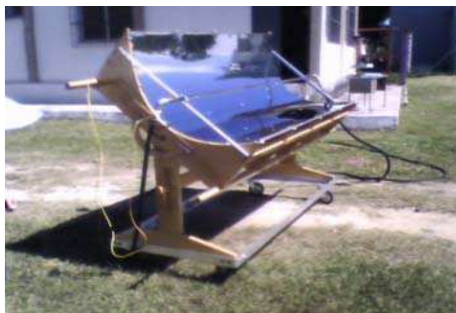
Figura 2 - Exemplo de concentrador solar do tipo calha
