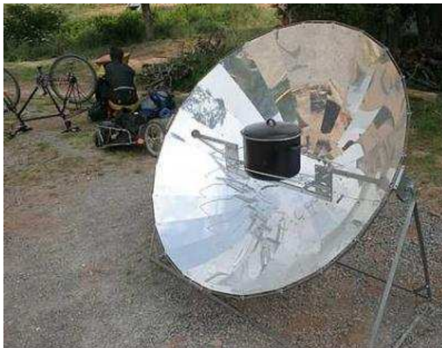
Figura 1 - Exemplo de concentrador solar do tipo prato
