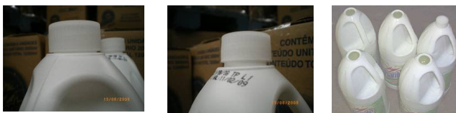
Figura 5 – Garrafa com deformação plástica no gargalo, garrafa sem deformação, garrafas decepadas.
