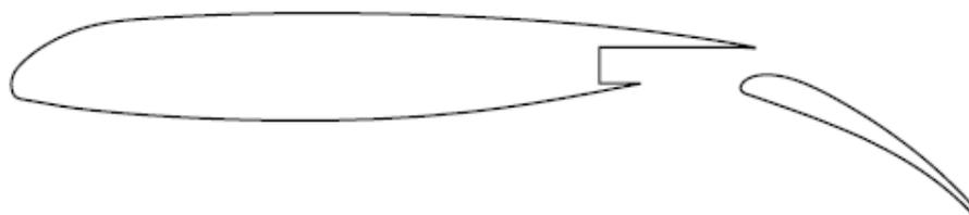
Figura 9. Fólio EET com flap tipo Fowler.
