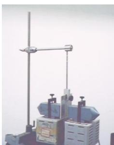
Figura 12: Freio Magnético experimental
