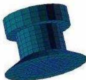
Figura 7: Modelo do Rebite após o Processo de Rebitagem
