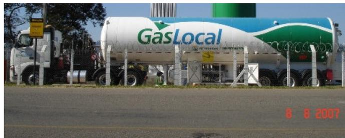
Figura 6. Exemplo de caminhão de transporte de GNL (Dahlgren e Steen, 2007).
