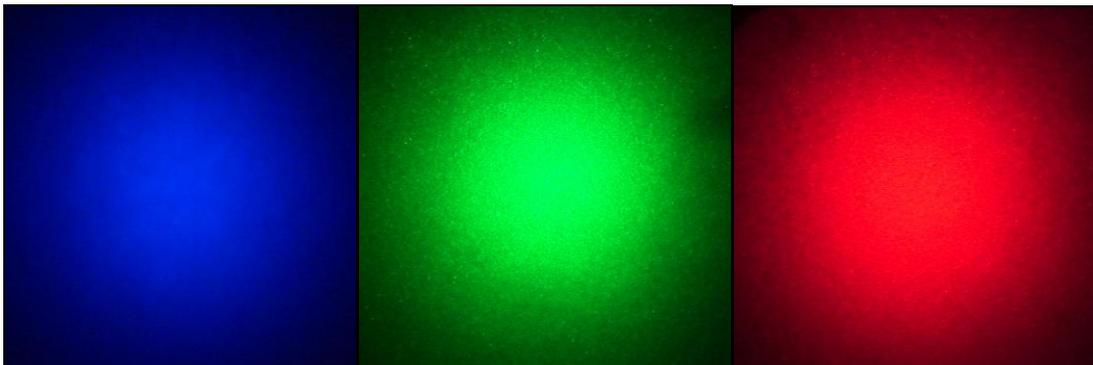
Figura 9: Teste realizado com a luz azul, verde e vermelha separadamente, incidindo sobre apenas 1 jateado.
