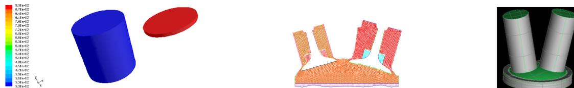
Fig. 3.1: À esquerda, temperaturas em um cilindro 3D com malhas dinâmicas. No centro, geometria utilizada na simulação do escoamento de ar 2D e à direita, geometria utilizada na simulação do escoamento de ar 3D
