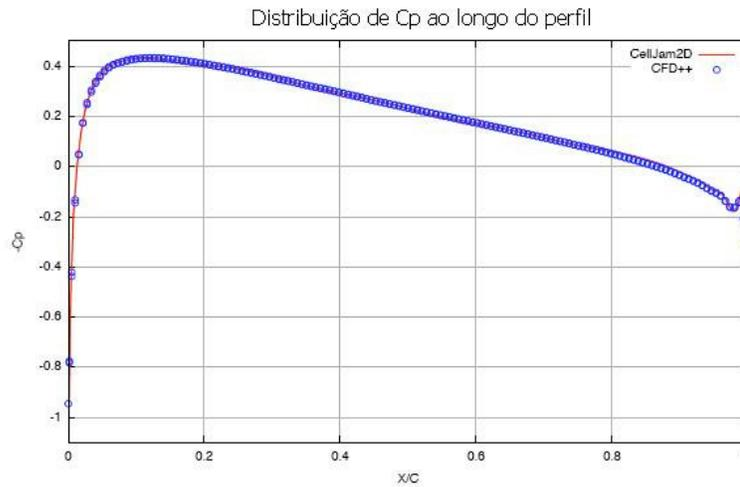
Figura 2.13 - Comparação dos resultados para o perfil NACA0012(0°)
