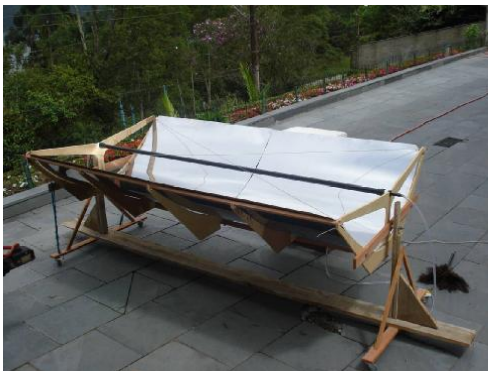
Foto 12 – Concentrador sendo ensaiado – vista lateral
