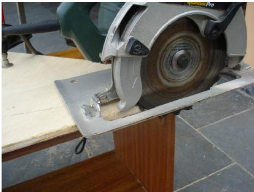
Foto 2 - Serra circular para cortes retos
