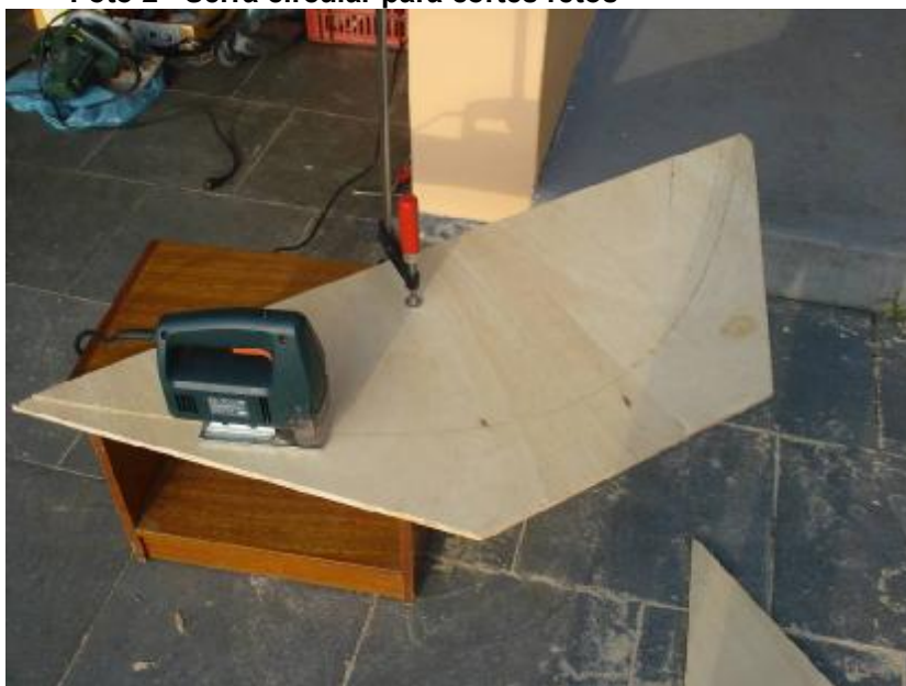
Foto 3 - Serra tico-tico para cortes curvos
