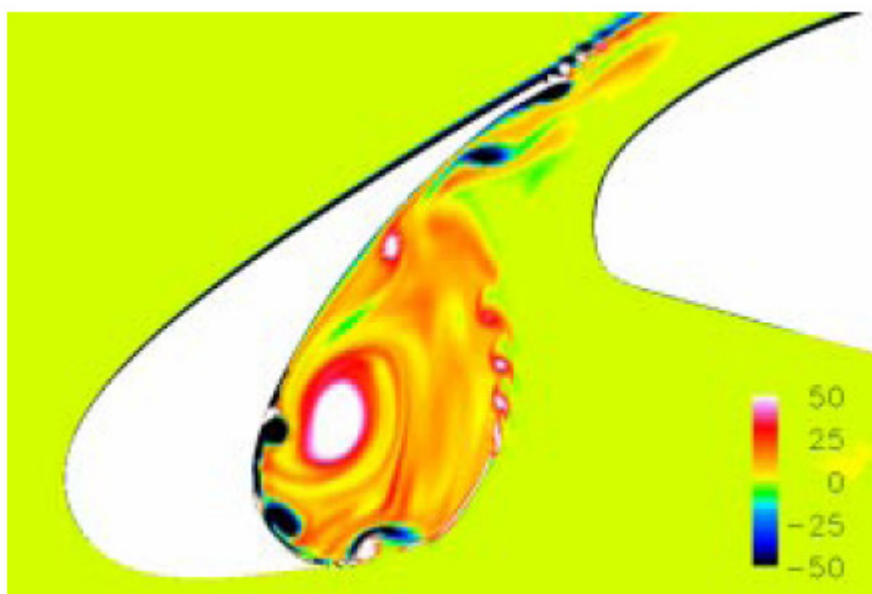
FIGURA 50. CAMPO DE VORTICIDADE PARA UM ESCOAMENTO COM Re=7,2 , MACH=0,2 , ÂNGULO DE ATAQUE DE 6 GRAUS, TRABALHO DO KHORRAMI ET AL. [14].
