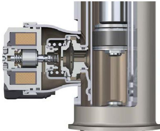
Figura 5: Desenho esquemático do amortecedor CDC (ZF-Sachs, 2008)
