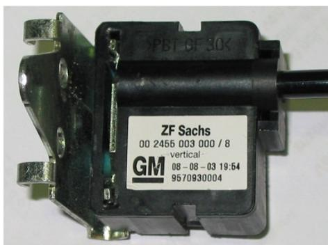
Figura 53: Exemplo de acelerômetro utilizado para a medição da cinemática em diversos pontos do veículo
