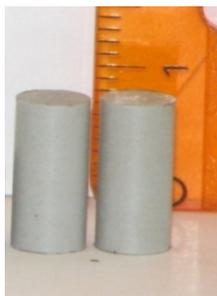
Figura 17: corpos de prova de compressão.
