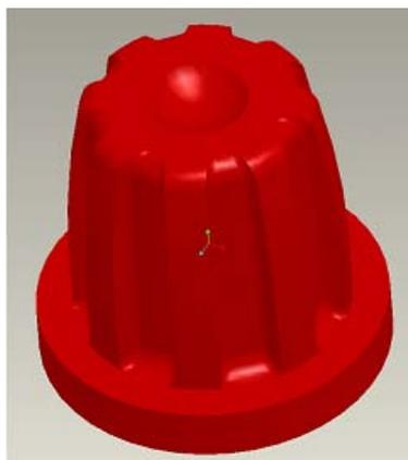
**Figura 1: batente plástico utilizado como absorvedor de impacto em sistema de suspensão de compressores de refrigeradores domésticos.**
