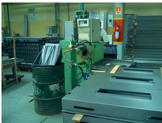
**Figura 3.3 Máquina de Solda**
