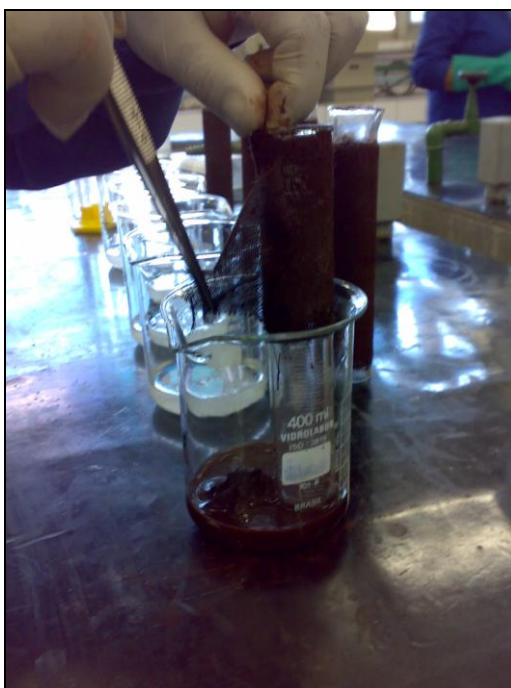
Fig. 36 – Separação da gaze impregnada do cilindro
