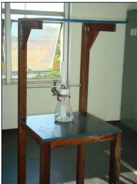
Fig. 15 –Vela úmida fixada no painel preparada para ser colocada na área.
