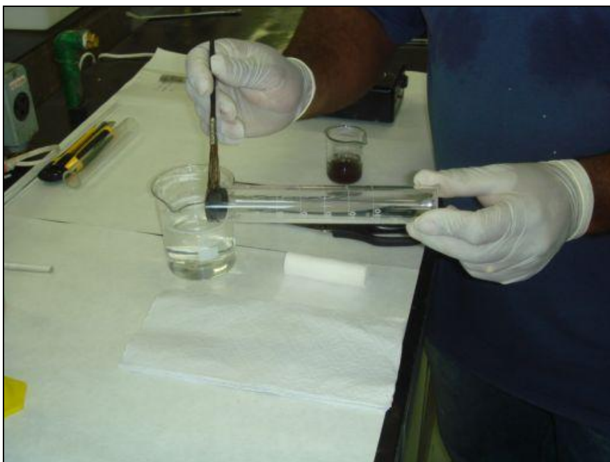
Fig. 22 – Aplicação da goma adragante sobre o cilindro de vidro para o preparo da vela.
