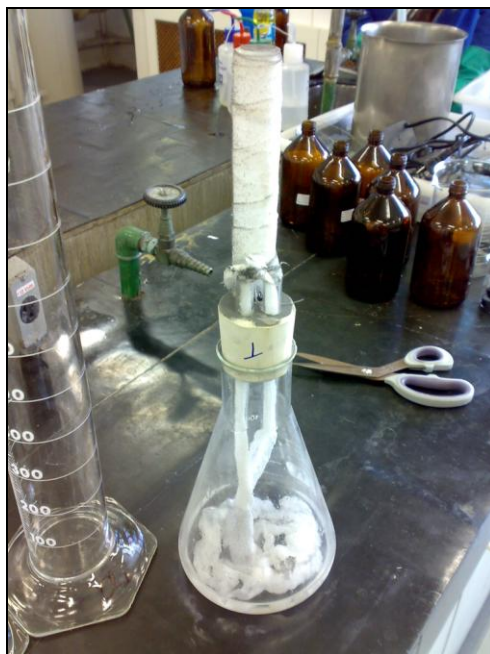
Fig. 31 – Vela de Cloreto pronta para análise.
