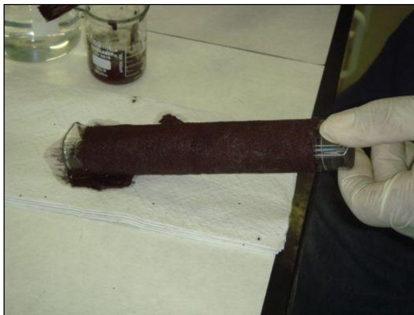
Fig. 26 – Recobrimento da camada de gaze cirúrgica com a pasta de dióxido de chumbo.
