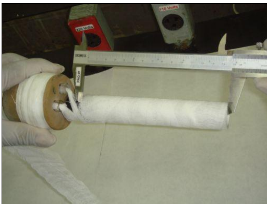
Fig. 10 – Medição do comprimento da vela para calcular a área de contato com a atmosfera.
