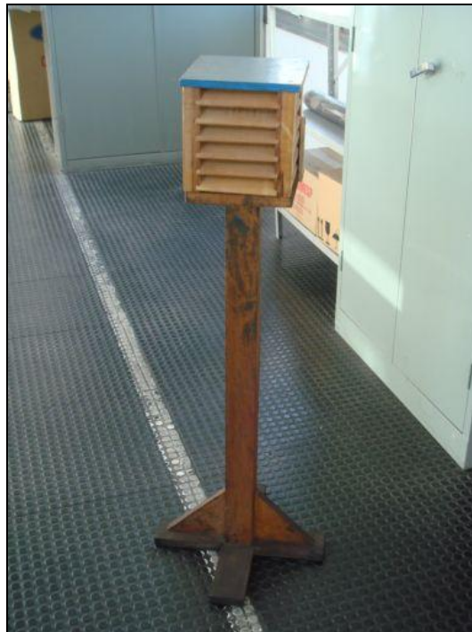
Fig. 30 – Vela de dióxido de chumbo pronta para instalação no local de ensaio.
