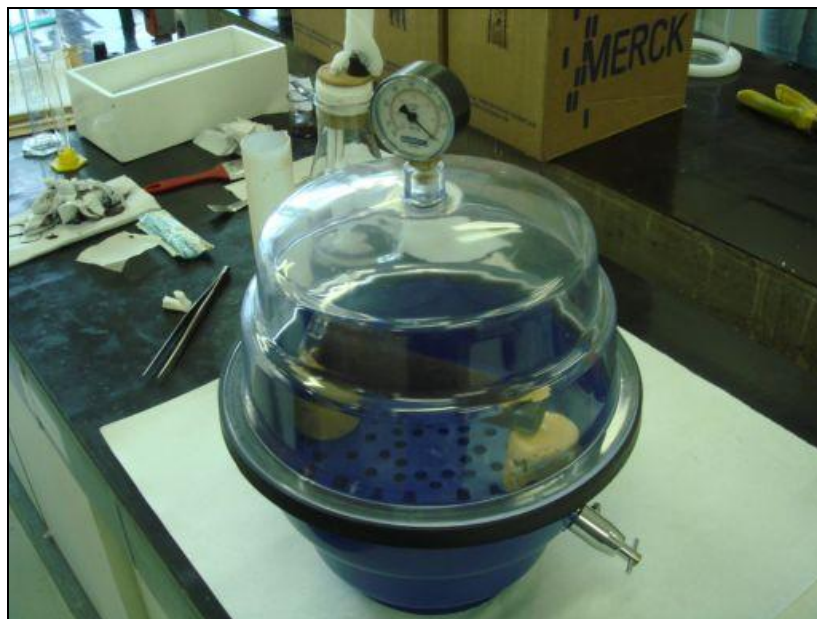
Fig. 27 – Repouso da vela em um dessecador por 24 horas.
