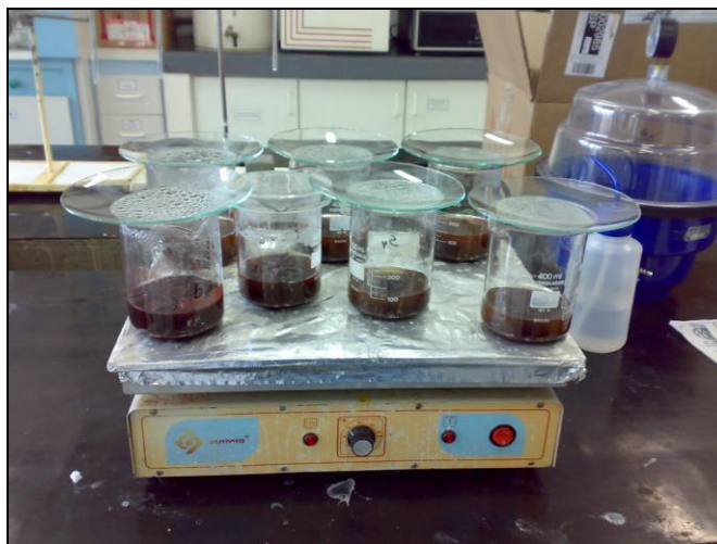
Fig. 37 – Aquecimento da mistura por 30 minutos
