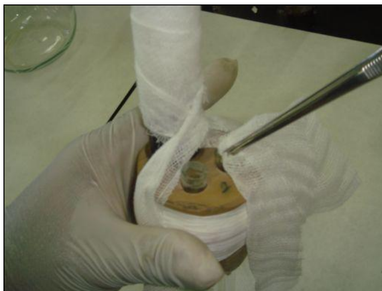
Fig. 8 – Passagem das duas pontas da gaze através dos pequenos tubos de vidro previamente fixados na rolha.
