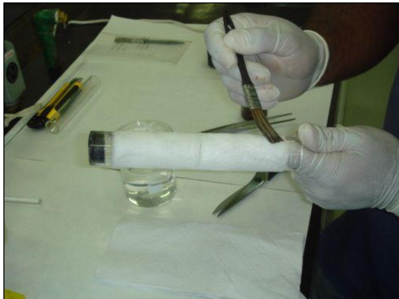
Fig. 24 – Recobrimento das camadas de gaze cirúrgicas com a goma adragante.
