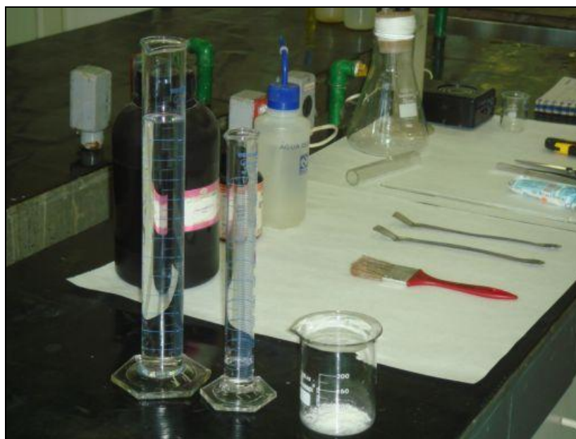
Fig. 17 – Materiais usados para preparação da pasta de goma adragante.
