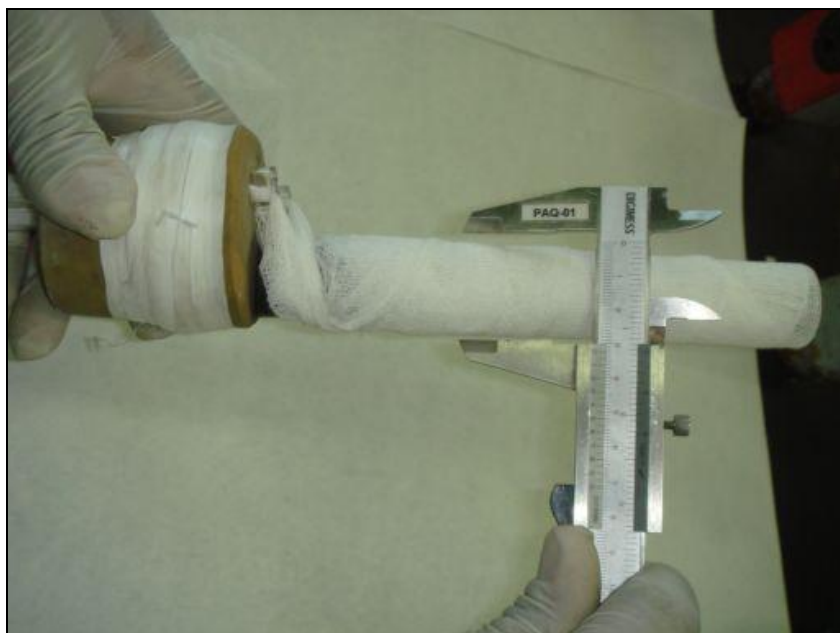
Fig. 11 – Medição do diâmetro da vela para calcular a área de contato com a atmosfera.
