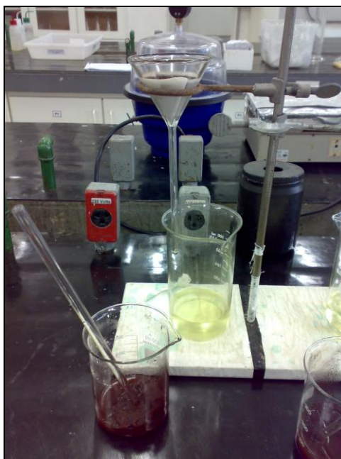
Fig. 38 – Filtração rápida do conteúdo
