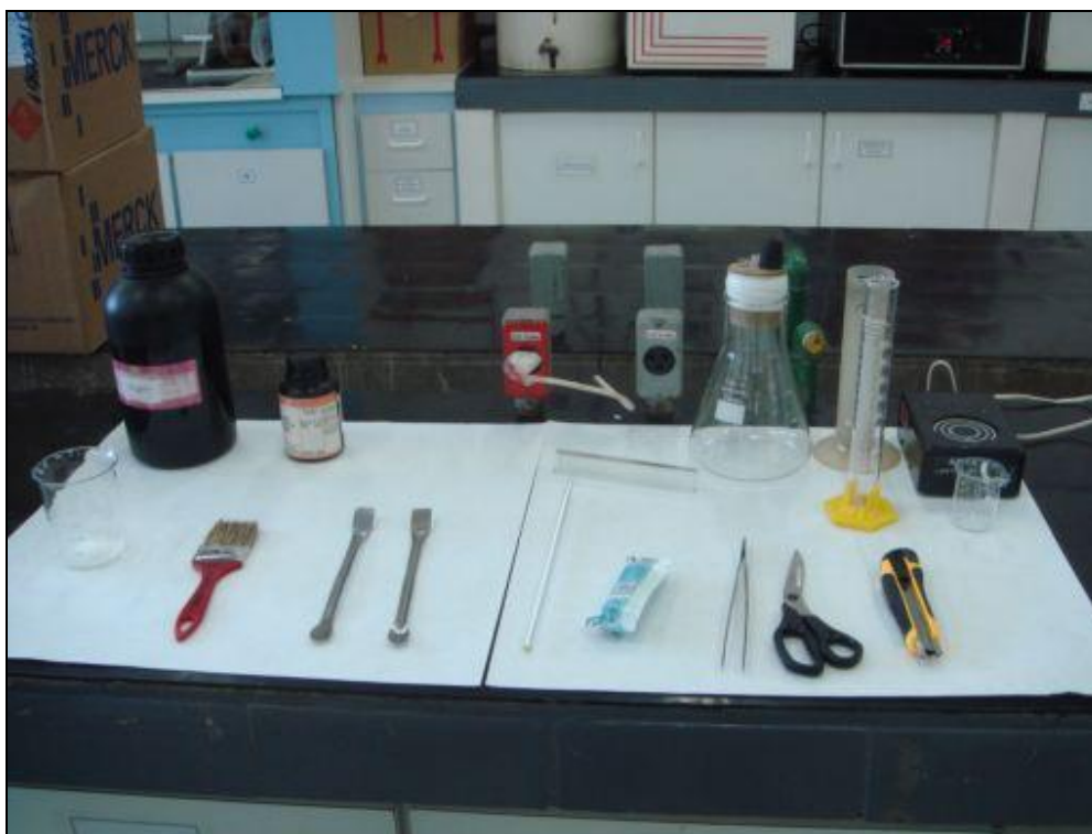
Fig. 16 – Materiais necessários para preparo da vela de dióxido de chumbo.
