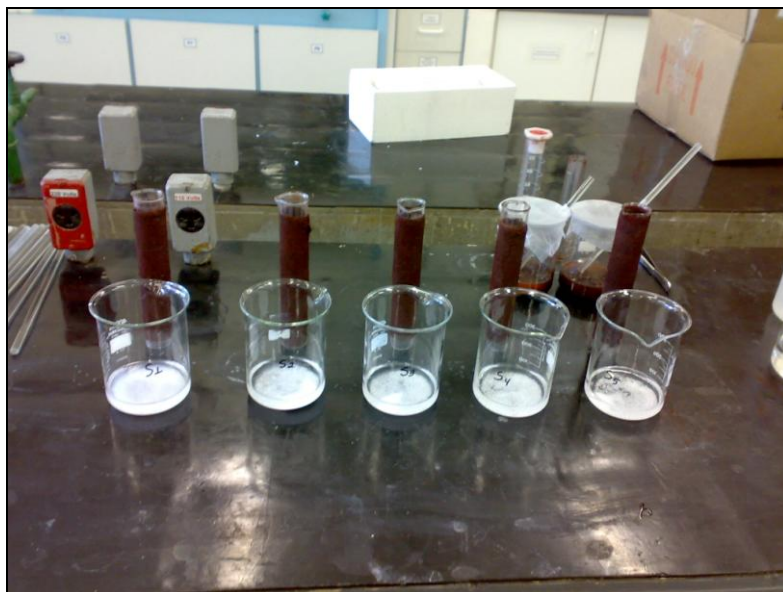
Fig. 35 – Velas de dióxido de chumbo e béqueres com 5 g de carbonato de sódio
