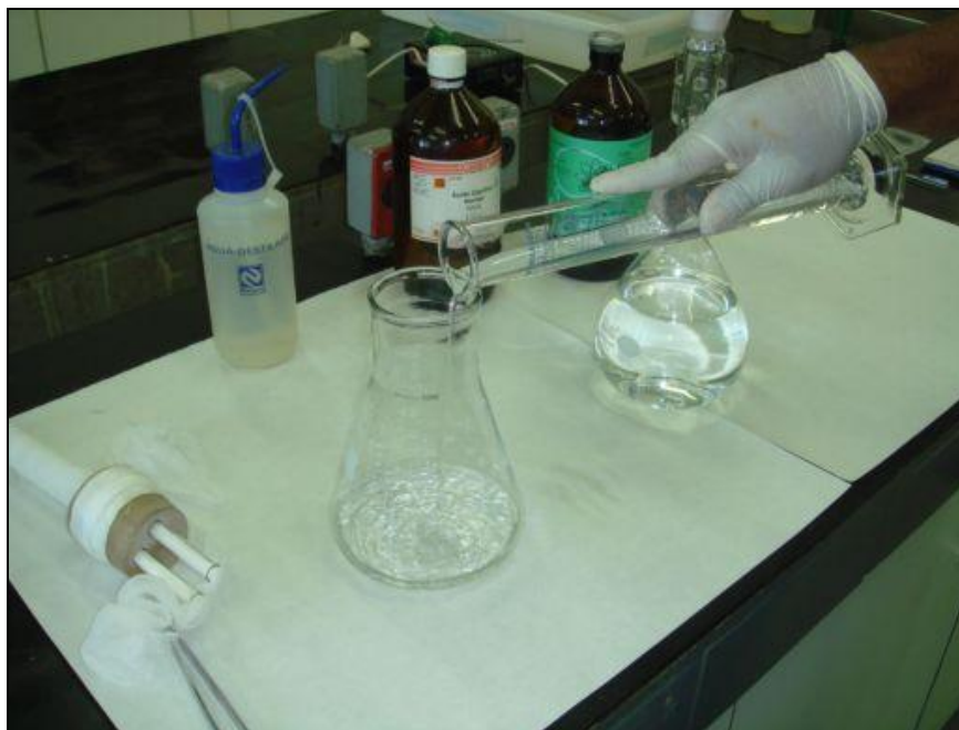
Fig. 13 – Colocação da solução de ensaio no Erlenmeyer.
