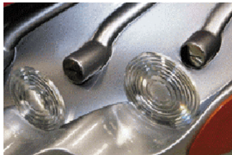
Figura 5.38: Fibra ótica em farol
