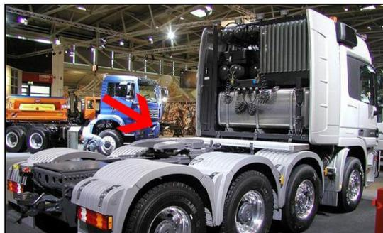
*Figura 5: Cavalo Mecânico com Quinta Roda*
