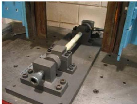
Figura 23 - Base para a fixação e pressurização de tubos.
