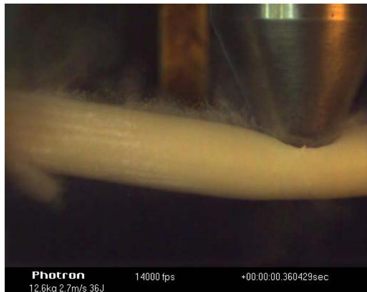
Figura 52 – Observação dos locais de vazamento de fluido durante o impacto.
