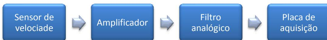
Figura 31 - Fluxograma dos equipamentos utilizados para a medição da velocidade de queda do indentador.
