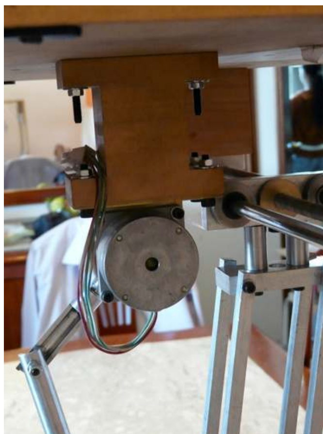
Figura 48 – Motor acoplado ao braço
