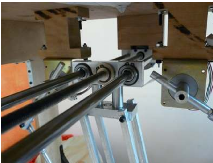
Figura 46 – Guia responsável pelo deslocamento em Y
