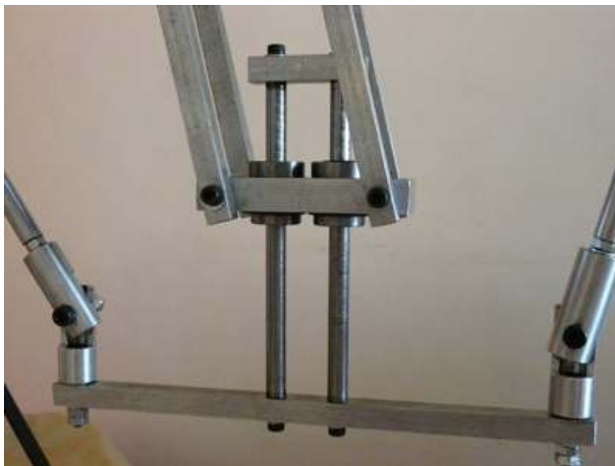
Figura 45 – Guia responsável pelo deslocamento em Z
