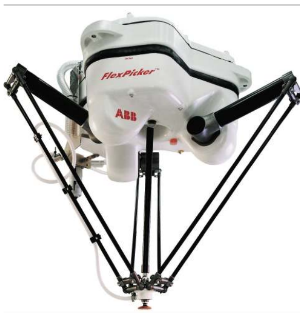
Figura 2 – Foto do IRB 340 fabricado pela empresa ABB
