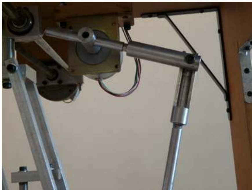
Figura 43 – Destaque para a junta esférica, vista frontal
