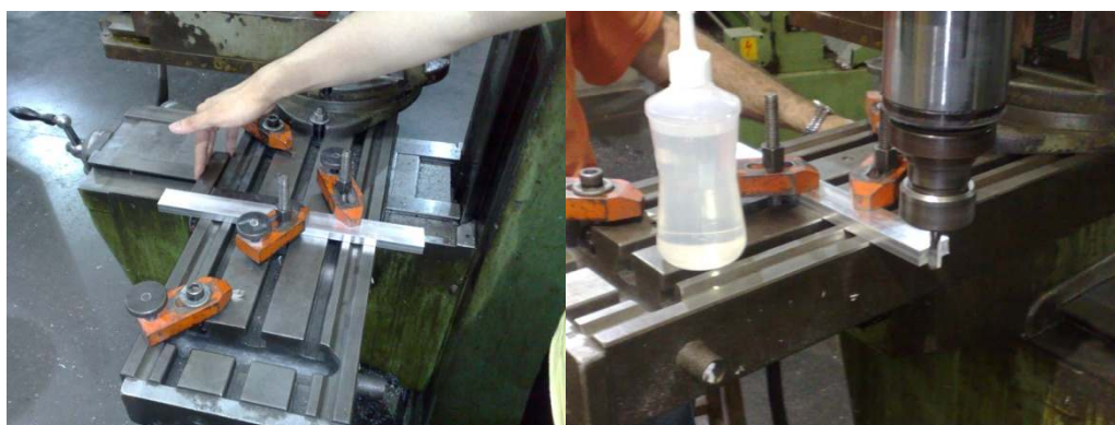
Figura 50 – Usinagem das laterais do bloco
