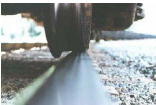
Figura 8 : Folga que ocorre em uma curva Fonte: Apostila do curso PTR2501-Ferrovias
