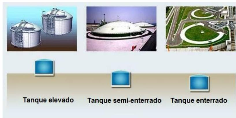
**Figura 2.1** - Principais tipos de sistemas de armazenamento (Tanque de superfície, tanque semi-enterrado e tanque enterrado) (TOKYO GAS, 2007).
