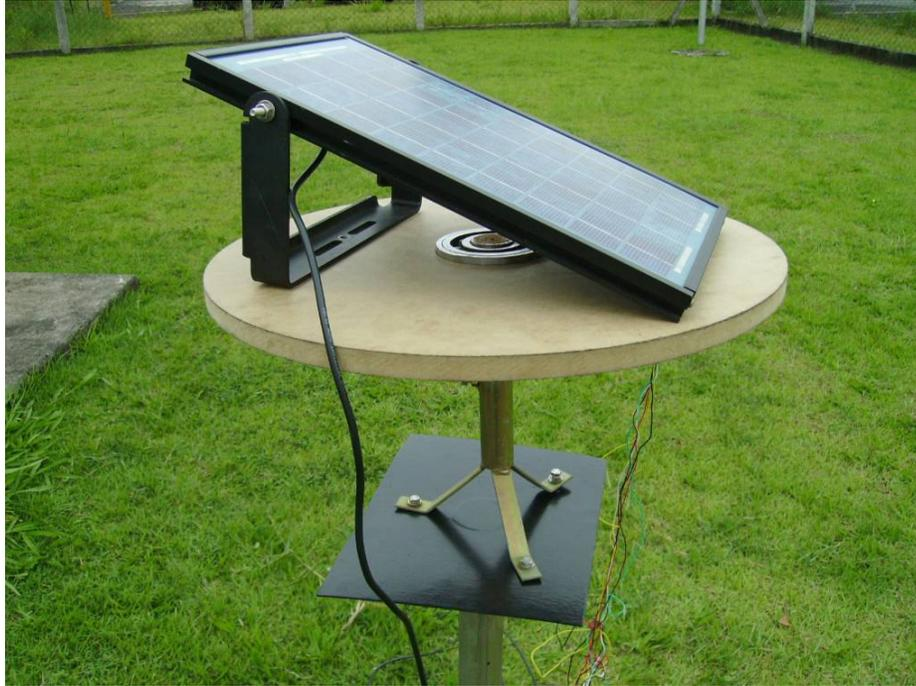
**Figura 29 - Mais detalhes do seguidor.**
