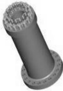
Fig. 8. Modelo 3D de um eixo superior, flangeado
