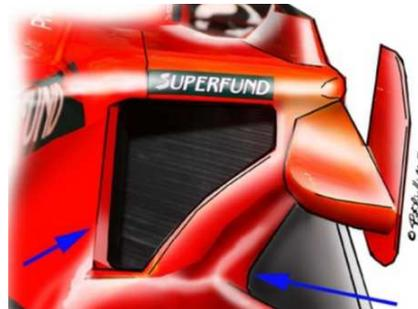
Figura 1: Tomada de ar lateral com radiador instalado. [3]
