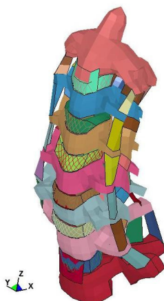
Figura 2. Modelo utilizado para as simulações de flexão/extensão, flexão lateral e rotação axial
